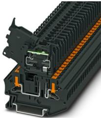
Morsetto portafusibili, tipo di fusibile: Vetro / ceramica / ..., tipo fusibile: G / 5 x 20, tensione nominale: 250 V, corrente nominale: 6,3 A, tipo di connessione: Connessione Push-in, 1. piano, Sezione di dimensionamento: 4 mm<sup>2</sup>, sezione: 0,2 mm<sup>2</sup>- 6 mm<sup>2</sup>, tipo di montaggio: NS 35/7,5, NS 35/15, colore: nero
