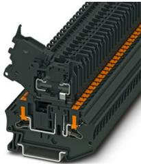
Morsetto portafusibili, tipo di fusibile: Vetro / ceramica / ..., tipo fusibile: G / 5 x 20, tensione nominale: 500 V, corrente nominale: 6,3 A, tipo di connessione: Connessione Push-in, 1. piano, Sezione di dimensionamento: 4 mm<sup>2</sup>, sezione: 0,2 mm<sup>2</sup>- 6 mm<sup>2</sup>, tipo di montaggio: NS 35/7,5, NS 35/15, colore: nero
