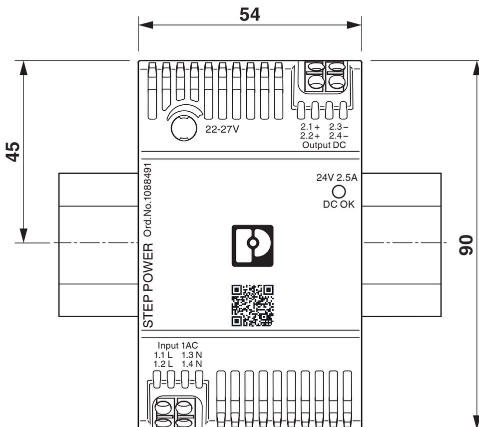
Dimensioni del dispositivo (misure in mm)
