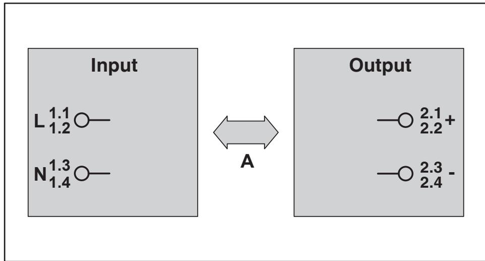
Percorsi di prova tensione di isolamento
