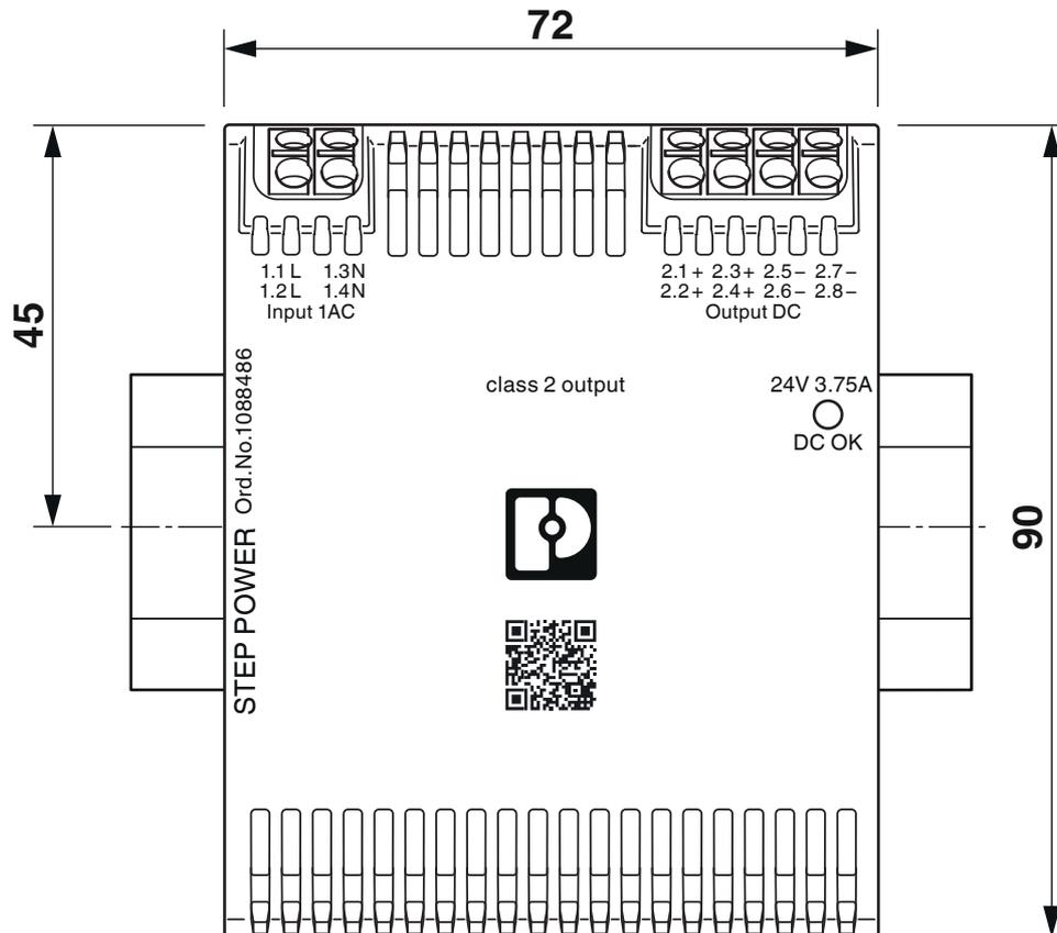
Dimensioni del dispositivo (misure in mm)
