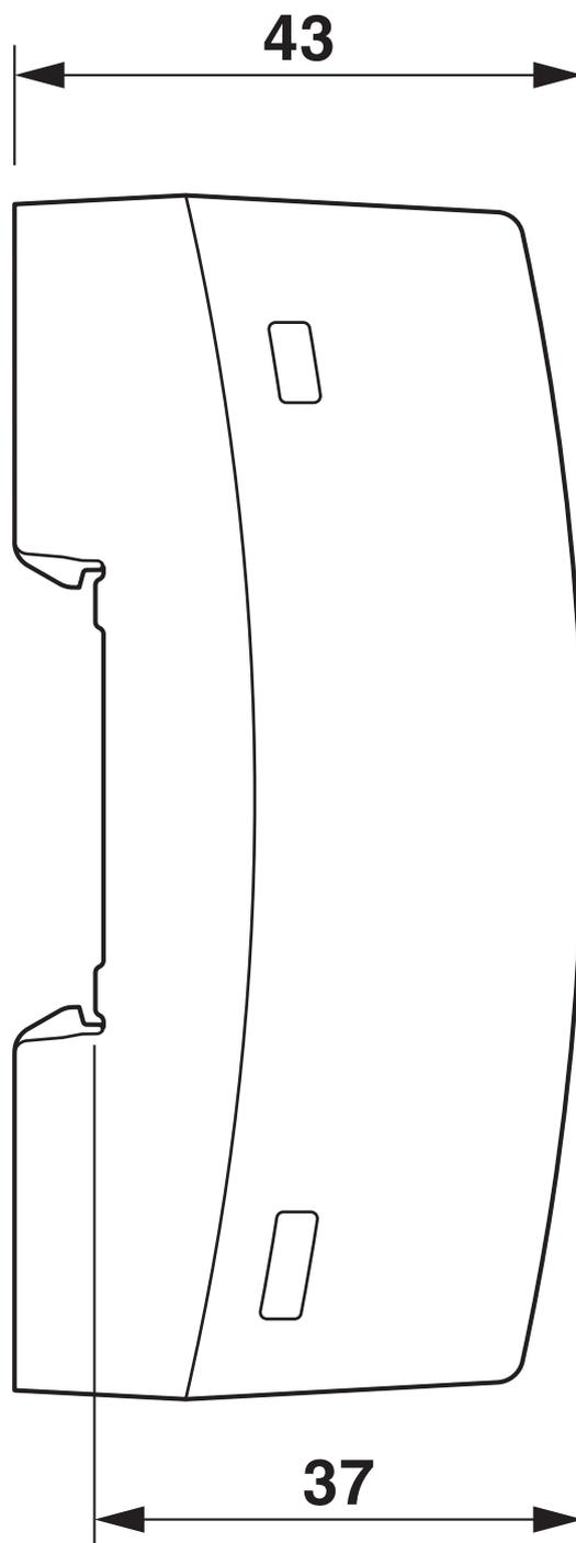
Dimensioni del dispositivo (misure in mm)
