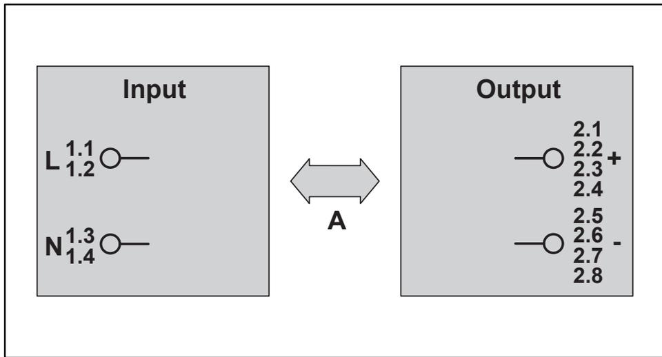
Percorsi di prova tensione di isolamento
