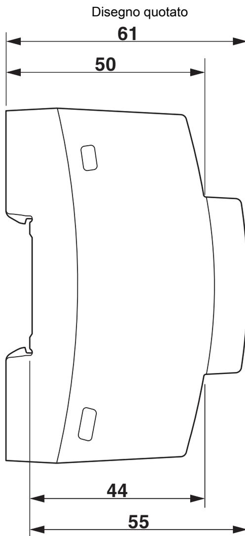
Dimensioni del dispositivo (misure in mm)
