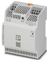
Alimentazione switching, STEP POWER, Connessione Push-in, Montaggio su guida DIN o diretto, ingresso: 1 fase, uscita: 24 V DC / 5 A, regolabile da 22 V DC ... 27 V DC
