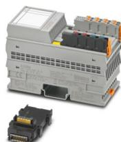
Axioline F, Modulo di uscita analogico, Uscite analogiche: 4 (HART), 0 mA ... 20 mA, 4 mA ... 20 mA, tecnica di connessione: 2 conduttori, velocità di trasmissione nel bus locale: 100 MBit/s, Variante per condizioni estreme:, Funzionalità HART, grado di protezione: IP20, incluso modulo di base bus e connettori Axioline F
