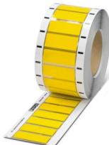
Guaina termoretraibile, Rotolo, giallo, in bianco, siglabile con: THERMOMARK E.300 (D)/600 (D), THERMOMARK ROLLMASTER 300/600, THERMOMARK ROLL X1, THERMOMARK ROLL, THERMOMARK ROLL 2.0, THERMOMARK X1.2, diametro cavi: 6,4 ... 12,7 mm, perforato, tipo di montaggio: infilamento, Numero dei cartellini singoli: 1000, altezza del campo di testo: 20 mm, larghezza del campo di testo: 30 mm
