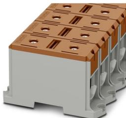
Morsetti di potenza, tensione nominale: 1000 V, corrente nominale: 380 A, numero di connessioni: 2, numero poli: 1, tipo di connessione: Connessione a vite, Sezione di dimensionamento: 240 mm<sup>2</sup>, sezione: 35 mm<sup>2</sup> - 240 mm<sup>2</sup>, Sezione di dimensionamento: 240 mm<sup>2</sup>, sezione: 35 mm<sup>2</sup> - 240 mm<sup>2</sup>, tipo di montaggio: Montaggio a vite, colore: marrone
