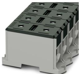
Morsetti di potenza, tensione nominale: 1000 V, corrente nominale: 380 A, numero di connessioni: 2, numero poli: 1, tipo di connessione: Connessione a vite, Sezione di dimensionamento: 240 mm<sup>2</sup>, sezione: 35 mm<sup>2</sup> - 240 mm<sup>2</sup>, Sezione di dimensionamento: 240 mm<sup>2</sup>, sezione: 35 mm<sup>2</sup> - 240 mm<sup>2</sup>, tipo di montaggio: Montaggio a vite, colore: nero
