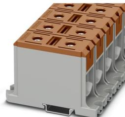
Morsetti di potenza, tensione nominale: 1000 V, corrente nominale: 290 A, numero di connessioni: 2, numero poli: 1, tipo di connessione: Connessione a vite, Sezione di dimensionamento: 150 mm<sup>2</sup>, sezione: 35 mm<sup>2</sup> - 150 mm<sup>2</sup>, Sezione di dimensionamento: 150 mm<sup>2</sup>, sezione: 35 mm<sup>2</sup> - 150 mm<sup>2</sup>, tipo di montaggio: NS 35/15, NS 35/7,5, colore: marrone
