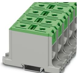
Morsetti di potenza, tensione nominale: 1000 V, corrente nominale: 220 A, numero di connessioni: 2, numero poli: 1, tipo di connessione: Connessione a vite, Sezione di dimensionamento: 95 mm<sup>2</sup>, sezione: 16 mm<sup>2</sup> - 95 mm<sup>2</sup>, Sezione di dimensionamento: 95 mm<sup>2</sup>, sezione: 16 mm<sup>2</sup> - 95 mm<sup>2</sup>, tipo di montaggio: NS 35/15, NS 35/7,5, colore: verde
