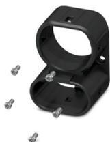
CHARX connect, CCS tipo 2, Kit di riparazione, Accessori, custodia: nero, con parte frontale del connettore sostituibile, con 5 viti a testa piatta M4X10 con impronta di sicurezza Torx (IPR TORX PLUS®), per la sostituzione della parte frontale dei connettori di ricarica lato veicolo, IEC 62196-3-1, Sostituzione senza svuotare il liquido di raffreddamento
