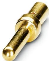
Contatto a crimpare, Spina, tornito, diametro contatti: 2 mm, intervallo di crimpatura: 1,5 mm<sup>2</sup> ... 2,5 mm<sup>2</sup>, Prodotto alternativo secondo RoHS II senza eccezione 6c (Pb < 0,1 %) cod. art.: 1238333
