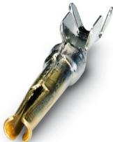
Contatto a crimpare, Femmina, in rotolo, diametro contatti: 1 mm, intervallo di crimpatura: 0,22 mm<sup>2</sup> ... 0,56 mm<sup>2</sup>, Contatto singolo, L'articolo è senza piombo secondo la direttiva RoHS II senza eccezione 6c (Pb < 0,1 %)
