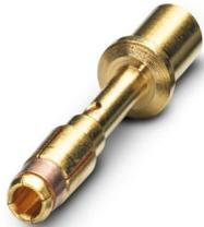
Contatto a crimpare, Femmina, tornito, diametro contatti: 2 mm, intervallo di crimpatura: 1 mm<sup>2</sup> .. 2,5 mm<sup>2</sup>, Prodotto alternativo secondo RoHS II senza eccezione 6c (Pb < 0,1 %) cod. art.: 1238318
