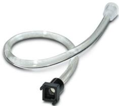
Fibra ottica flessibile, trasparente 3 mm in PUR con lente da 6 mm in PMMA cristallino e custodia LED 6 x 6 mm in PC nero, UL 94 HB, lunghezza: 150 mm non montato, per SMD TOPLED
