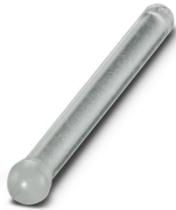
Conduttore in fibra ottica verticale 4 mm, trasparente, con testa della lente sferica 5,2 mm, montaggio per spessore parete a partire da 1 mm, in policarbonato (UL 94-V0), lunghezza di incasso 45 mm, impermeabile, IP68 (EN 50529)
