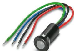
Segnalatore luminoso 10 mm con SMD LED 5 mm (colore RGB) per il montaggio per spessore parete a partire da 1,5 mm. Custodia in policarbonato nero (UL 94-V0) con 4 estremità del cavo libere 94 mm stagnato, impermeabile IP68 (EN 60529)
