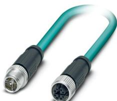
Cavo di rete, Ethernet CAT6<sub>A</sub> (10 Gbit/s) CAT6<sub>A</sub> (10 Gbit/s), 8-poli, PUR senza alogenati, azzurro mare RAL 5021, schermata (Advanced Shielding Technology), Maschio diritto M12, codifica: X / IP67, su Connnettore femmina diritto M12, codifica: X / IP67, lunghezza cavo: 5 m
