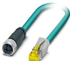
Cavo di rete, Ethernet CAT6<sub>A</sub> (10 Gbit/s) CAT6<sub>A</sub> (10 Gbit/s), 8-poli, PUR senza alogenati, azzurro mare RAL 5021, schermata (Advanced Shielding Technology), Maschio diritto RJ45 / IP20, su Connnettore femmina diritto M12, codifica: X / IP67, lunghezza cavo: 10 m
