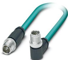
Cavo di rete, Ethernet CAT6<sub>A</sub> (10 Gbit/s) CAT6<sub>A</sub> (10 Gbit/s), 8-pol, PUR senza alogenati, azzurro mare RAL 5021, schermata (Advanced Shielding Technology), Maschio diritto M12, codifica: X / IP67, su Maschio angolato M12, codifica: X / IP67, lunghezza cavo: 1 m
