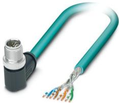
Cavo di rete, Ethernet CAT6<sub>A</sub> (10 Gbit/s) CAT6<sub>A</sub> (10 Gbit/s), 8-poli, PUR senza alogenati, azzurro mare RAL 5021, schermata (Advanced Shielding Technology), Maschio angolato M12, codifica: X / IP67, su estremità conduttore libera, lunghezza cavo: 2 m
