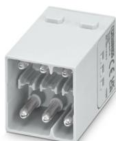
Modulo portacontatti, numero poli: 6, Spina, Connessione Push-in, 100 V, 20 A, 1,5 mm<sup>2</sup> ... 4 mm<sup>2</sup>, con funzione di cortocircuito
