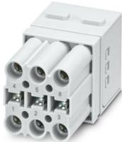
Modulo portacontatti, numero poli: 6, Femmina, Connessione Push-in, 100 V, 20 A, 1,5 mm<sup>2</sup> ... 4 mm<sup>2</sup>, con funzione di cortocircuito
