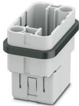
Inserto contatti, numero poli: 8+PE, dimensioni: COM, contatti di potenza: 8, contatti di comando: 0, numero di connessioni per polo: 1, Spina, Connessione a crimpare, 320 V, 16 A, 0,5 mm<sup>2</sup> ... 4 mm<sup>2</sup>, applicazione: Potenza
