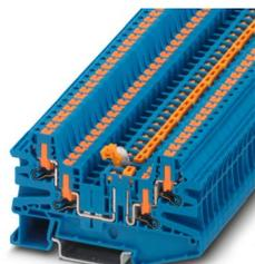
Morsetto con sezionatore a coltello, tensione nominale: 400 V, corrente nominale: 20 A, tipo di connessione: Connessione Push-in, Sezione di dimensionamento: 2,5 mm<sup>2</sup>, sezione: 0,14 mm<sup>2</sup> - 4 mm<sup>2</sup>, colore: blu
