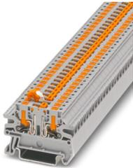
Morsetto con sezionatore a coltello, tensione nominale: 400 V, corrente nominale: 20 A, tipo di connessione: Connessione Push-in, Sezione di dimensionamento: 2,5 mm<sup>2</sup>, sezione: 0,14 mm<sup>2</sup> - 4 mm<sup>2</sup>, montaggio: NS 35/7,5, NS 35/15, colore: grigio
