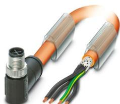
Cavo di alimentazione, 4-poli, PUR senza alogenati, arancio RAL 2003, schermata (Advanced Shielding Technology), Maschio angolato M12, codifica: S, su estremità conduttore libera, lunghezza cavo: 15 m, per corrente alternata fino a 12 A/690 V
