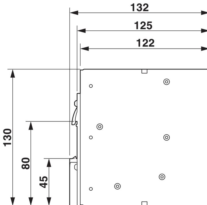
Dimensioni del dispositivo (misure in mm)
