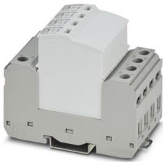
Scaricatore di sovratensioni ad innesto, secondo tipo 2/Classe II, per reti di alimentazione trifase con N e PE separato (sistema a 5 conduttori: L1, L2, L3, N, PE), con contatto FM.
