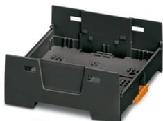
Custodie per guide DIN, Base custodia con piedino di fissaggio, design piatto, senza feritoia di ventilazione, larghezza: 70,1 mm, altezza: 75 mm, profondità: 30,3 mm, colore: nero (simili RAL 9005), collegamento trasversale: senza connettore bus, n. poli connettore trasversale: non rilevante
