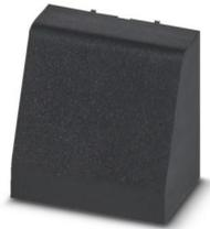
Custodie per guide DIN, Tappi ciechi per punti di collegamento inutilizzati (struttura alta), larghezza: 21,35 mm, altezza: 19,65 mm, profondità: 13,67 mm, colore: nero (simili RAL 9005)
