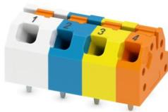
Morsetto circuito stampato, corrente nominale: 16 A, sezione nominale: 1,5 mm<sup>2</sup>, numero di file: 1, numero di poli per fila: 4, serie di prodotti: SPTAF 1/..-IL-EX PROFINET, passo: 5 mm, tipo di connessione: Connessione a molla Push-in, montaggio: Saldatura a onde, direzione di collegamento conduttore/scheda: 45 °, colore: verde, Layout Pin: Pinning lineare, Lunghezza pin [P]: 2,6 mm, numero di pin di saldatura per potenziale: 2, tipo di confezione: Tray. Adatto per CAT5
