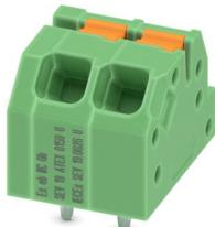
Morsetto circuito stampato, corrente nominale: 16 A, sezione nominale: 1,5 mm<sup>2</sup>, numero di file: 1, numero di poli per fila: 12, serie di prodotti: SPTAF 1/..-IL-EX, passo: 3,5 mm, tipo di connessione: Connessione a molla Push-in, montaggio: Saldatura a onde, direzione di collegamento conduttore/scheda: 45 °, colore: verde, Layout Pin: Pinning lineare, Lunghezza pin [P]: 2,6 mm, numero di pin di saldatura per potenziale: 2, tipo di confezione: Tray
