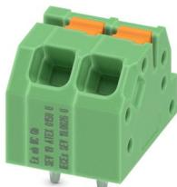
Morsetto circuito stampato, corrente nominale: 16 A, sezione nominale: 1,5 mm<sup>2</sup>, numero di file: 1, numero di poli per fila: 3, serie di prodotti: SPTAF 1/..-IL-EX, passo: 3,5 mm, tipo di connessione: Connessione a molla Push-in, montaggio: Saldatura a onde, direzione di collegamento conduttore/scheda: 45 °, colore: verde, Layout Pin: Pinning lineare, Lunghezza pin [P]: 2,6 mm, numero di pin di saldatura per potenziale: 2, tipo di confezione: Tray
