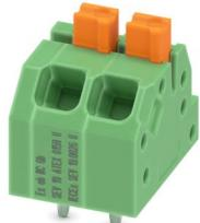
Morsetto circuito stampato, corrente nominale: 16 A, sezione nominale: 1,5 mm<sup>2</sup>, numero di file: 1, numero di poli per fila: 11, serie di prodotti: SPTAF 1/..-EL-EX, passo: 3,5 mm, tipo di connessione: Connessione a molla Push-in, montaggio: Saldatura a onde, direzione di collegamento conduttore/scheda: 45 °, colore: verde, Layout Pin: Pinning lineare, Lunghezza pin [P]: 2,6 mm, numero di pin di saldatura per potenziale: 2, tipo di confezione: Tray
