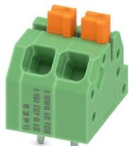
Morsetto circuito stampato, corrente nominale: 16 A, sezione nominale: 1,5 mm<sup>2</sup>, numero di file: 1, numero di poli per fila: 10, serie di prodotti: SPTAF 1/..-EL-EX, passo: 3,5 mm, tipo di connessione: Connessione a molla Push-in, montaggio: Saldatura a onde, direzione di collegamento conduttore/scheda: 45 °, colore: verde, Layout Pin: Pinning lineare, Lunghezza pin [P]: 2,6 mm, numero di pin di saldatura per potenziale: 2, tipo di confezione: Tray
