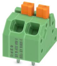
Morsetto circuito stampato, corrente nominale: 16 A, sezione nominale: 1,5 mm<sup>2</sup>, numero di file: 1, numero di poli per fila: 2, serie di prodotti: SPTAF 1/..-EL-EX, passo: 3,5 mm, tipo di connessione: Connessione a molla Push-in, montaggio: Saldatura a onde, direzione di collegamento conduttore/scheda: 45 °, colore: verde, Layout Pin: Pinning lineare, Lunghezza pin [P]: 2,6 mm, numero di pin di saldatura per potenziale: 2, tipo di confezione: Tray
