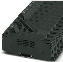
Morsetto portafusibili, tipo di fusibile: Vetro / ceramica / ..., tipo fusibile: gG / gPV / 10,3 x 85, tensione nominale: 1500 V DC, corrente nominale: 32 A, numero poli: 1, tipo di connessione: Connessione a vite, Sezione di dimensionamento: 16 mm<sup>2</sup>, sezione: 2,5 mm<sup>2</sup>- 25 mm<sup>2</sup>, tipo di montaggio: NS 35/7,5, NS 35/15, colore: nero
