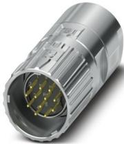
M23, Connettore per cavi, serie: M23 PRO, diritto, schermati: sì, Bloccaggio rapido ONECLICK, Numero di poli: 12, Senso di rotazione: Invertito, tipo di connessione del contatto: Spina, Connessione a crimpare, diametro cavi: 3 mm ... 15 mm, codifica: N, L'articolo è senza piombo secondo la direttiva RoHS II senza eccezione 6c (Pb < 0,1 %)
