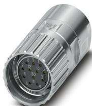
M23, Connnettore per cavi, serie: M23 PRO, diritto, schermati: sì, Bloccaggio a vite, Numero di poli: 12, Senso di rotazione: Invertito, tipo di connessione del contatto: Femmina, Connessione a crimpare, diametro cavi: 9 mm ... 15 mm, codifica: N, L'articolo è senza piombo secondo la direttiva RoHS II senza eccezione 6c (Pb < 0,1 %)
