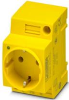
Presa di corrente, con LED, Piano d'inserimento tipo CF, tipo di connessione: Connessione a vite, colore: giallo, tensione nominale: 250 V AC (50 Hz), corrente nominale: 16 A, per montaggio su guida di montaggio nell'interfaccia di servizio o per montaggio diretto, norme/disposizioni: VDE 0620-1, IEC 60884-1, Contrassegno del paese: Germania
