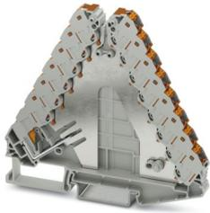
Ripartitore di potenziale, Con possibilità di alimentazione fino a  $6 \text{ mm}^2$ , tensione nominale: 250 V, corrente nominale: 17,5 A, tipo di connessione: Connessione Push-in, Sezione di dimensionamento:  $1,5 \text{ mm}^2$ , sezione:  $0,14 \text{ mm}^2 - 2,5 \text{ mm}^2$ , Piano di alimentazione, Sezione di dimensionamento:  $4 \text{ mm}^2$ , sezione:  $0,2 \text{ mm}^2 - 6 \text{ mm}^2$ , montaggio: NS 35/7,5, NS 35/15, colore: grigio, elementi di connessione colore: marrone
