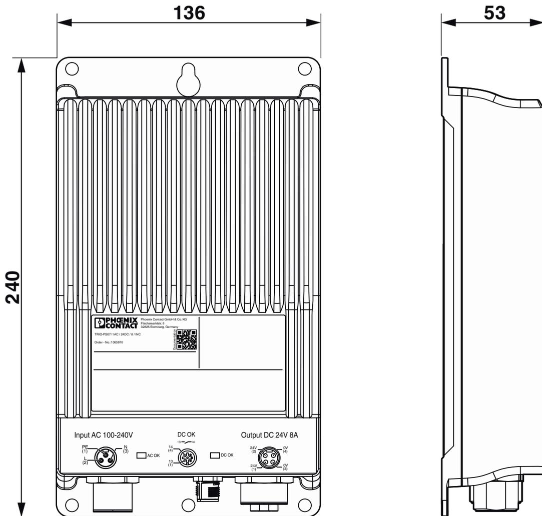
Dimensioni del dispositivo (misure in mm)
