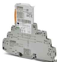
Protezione contro la sovratensione, composta da spina estraibile ed elemento base, con indicatore di stato integrato per due fili di segnale con potenziale di riferimento comune, ad es. digitale IN/OUT. Messa a terra indiretta mediante scaricatore a gas. Utilizzabile nei circuiti di sicurezza fino a SIL 3.
