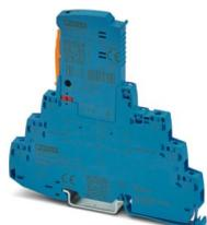
Protezione contro la sovratensione, composta da spina estraibile ed elemento base, con indicatore di stato integrato per un circuito del segnale Ex-i libero da potenziale di terra a 3 fili, compatibile con HART. Utilizzabile nei circuiti di sicurezza fino a SIL 3.
