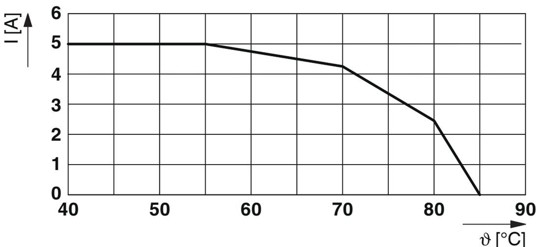
Derating per zone non a potenziale rischio di esplosione e zone a potenziale rischio di esplosione (zona 2, EX ec)
