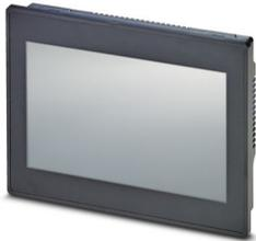
Pannello web con 17.8 cm / 7"-TFT display (analogico-resistivo), 800 x 480 pixel (WVGA), 16,7 milioni di colori, i.MX 6DualLite, 1 GHz, 1x USB Host 2.0, 1x Ethernet (10/100 MBit/s), RJ45, Yocto/Linux® e software utente: Browser QT. (sistema bus: assente)
