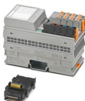
Axioline F, Modulo di ingresso analogico, Ingressi analogici attivi: 8 (HART), 4 mA ... 20 mA, tecnica di connessione: 2 conduttori, velocità di trasmissione nel bus locale: 100 MBit/s, Variante per condizioni estreme:, Funzionalità HART, Funzionalità HART, grado di protezione: IP20, incluso modulo di base bus e connettori Axioline F
