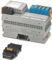
Axioline F, Modulo di ingresso analogico, Ingressi analogici attivi: 8 (HART), 4 mA ... 20 mA, tecnica di connessione: 2 conduttori, velocità di trasmissione nel bus locale: 100 MBit/s, Variante per condizioni estreme:, sicurezza intrinseca, Funzionalità HART, grado di protezione: IP20, incluso modulo di base bus e connettori Axioline F
